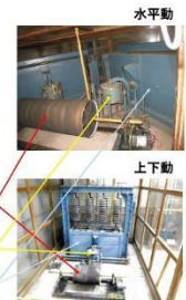
図7. 京都大学桜島火山観測所所蔵の現在稼働中の地震計および微気圧計の一般向け説明図 (京都大学防災研究所[課題番号: DPRI13])
