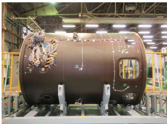
第2段機器搭載構造
