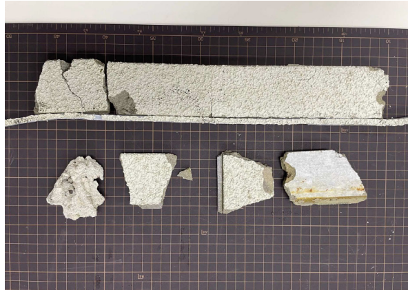
【事例 7】 体育館の外壁のモルタルの一部が落下。
