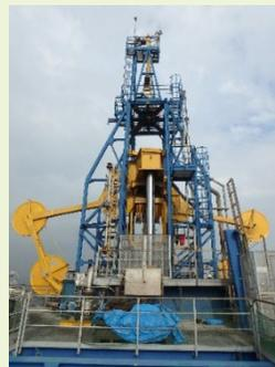
船体の動揺が掘削パイプへ伝搬するのを軽減する設備や、孔内圧力調整に必須のライザー機器が老朽化しており、重大故障時には長期間ライザー掘削作業ができなくなる。
