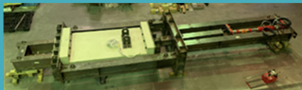
治具と試験体の構成（試験前）
