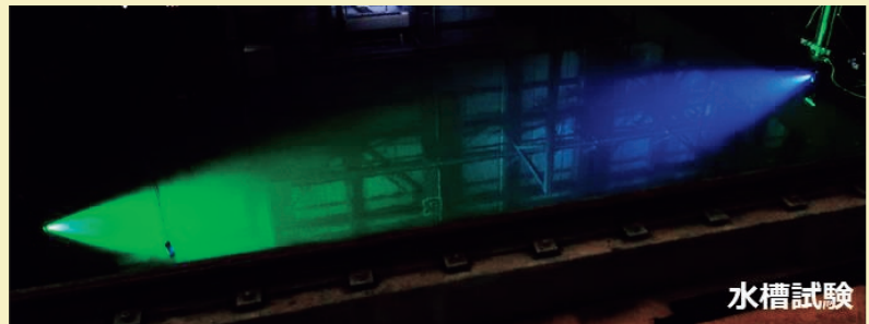
光／音響ハイブリッド水中通信の水槽試験 提供：防衛装備庁
