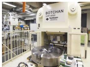
世界最大超高压合成装置「BOTCHAN」
