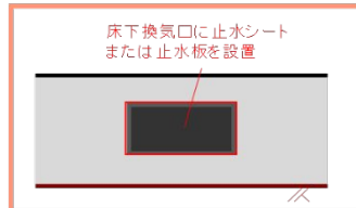
床下換気口の浸水対策イメージ
