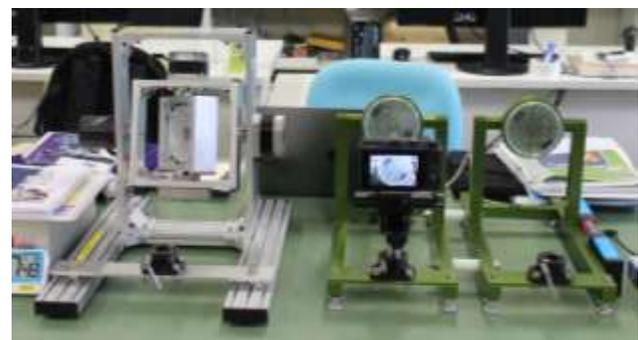
図6 3Dクリノスタット：模擬微小重力発生装置
