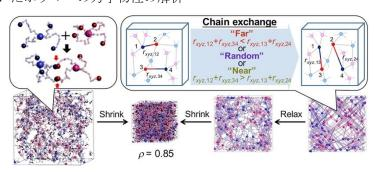
中心性指標を開発した。重み付きネットワーク表現を用いてエラストマーの力学物性を解析した結果、ネットワークの中心にいる架橋点、かつ、初期の架橋点間距離が大きい架橋点ほど応力に対して寄与すること、距離を考慮した新たな近接中心性の指標を導入したことで架橋点間距離と架橋点のゆらぎの両方を統一的に記述できることを明らかにした。これにより、伸びきり鎖による応力集中の記述も可能になった。[文献 20]
