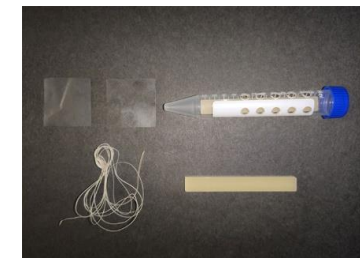
「江戸っ子1号」を利用した深海底での生分解プラスチック分解試験 https://www.jamstec.go.jp/j/about/press_release/20200305/
