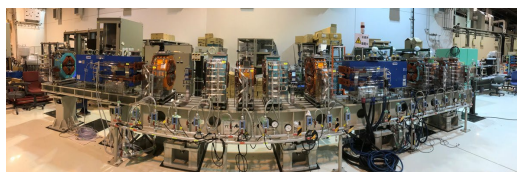
蓄積リング磁石セル (ハーフセル)
