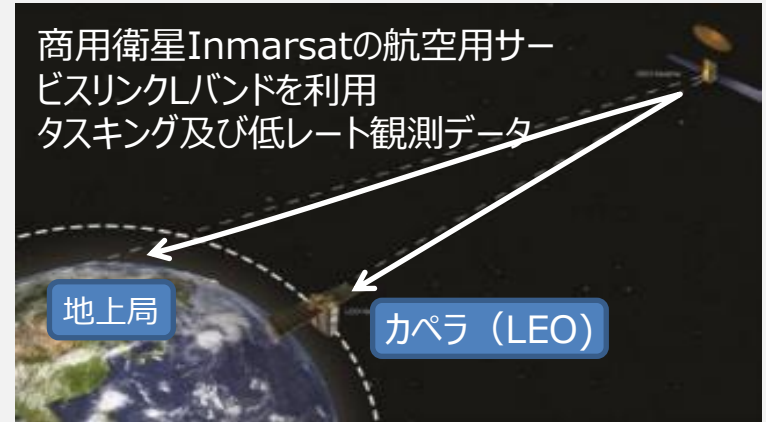
Inmarsat及びAddvalue社によるCapella SAR画像・TT&Cの中継 Inmarsat-4の有している商用バンド(BGAN)を用いたサービス、が提供 【出展：Spacenews】
