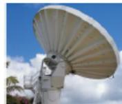
図⑦：Ka/Q/V帯ゲートウェイアンテナ
