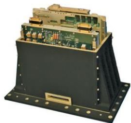
小型衛星では、Ultrascaleを使用しルータと送受信機を一体にできるが、大型通信衛星では、一機当たりのスループットが1~2桁大きいためルーティング専用のユニット(DPP)を持つことになる。
