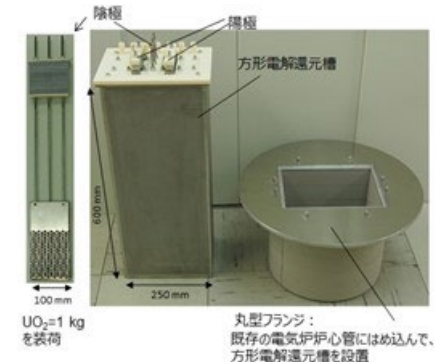
試作した工学規模電解還元装置の電極部 (R2)
