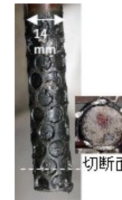
電解還元後の陰極と切断面の例(R3)
