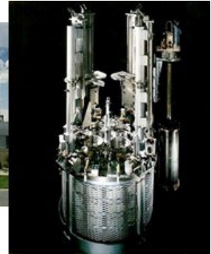
INLの乾式再処理施設FCFと電解精製装置の外観
