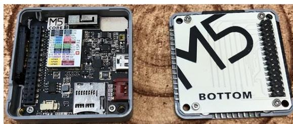
図1 M5Stack(展開時)の内部構造
