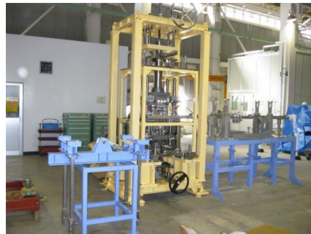
パレット成型設備のモジュール交換のモックアップ試験機
