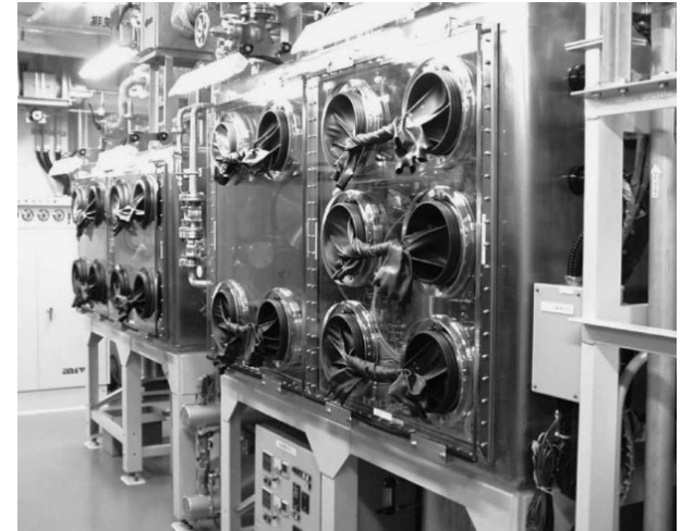
燃料研究棟に整備した Arガス雰囲気グローブボックス
