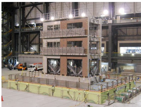
災害拠点建物の災害時機能継続性検証のため、令和元年12月に実施した3階建て鉄筋コンクリート造建物試験体のE-ディフェンス振動台実験の様子
