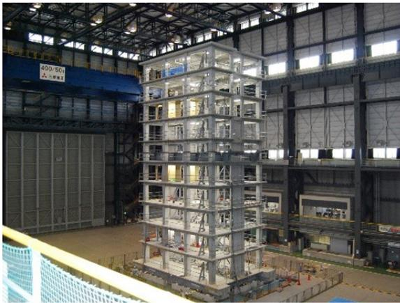
耐震性能の検証のため、平成30年12月と平成31年1月に実施した10階建て鉄筋コンクリート建造物試験体のE-ディフェンス振動台実験の様子
