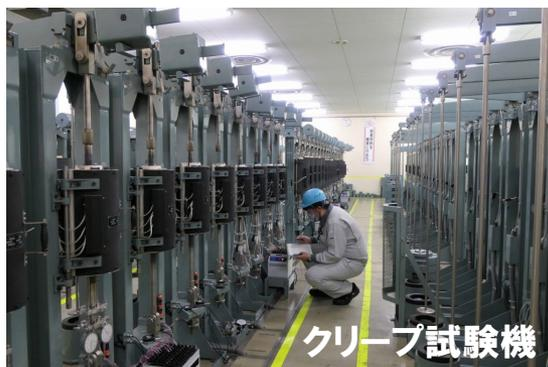
構造材料長時間試験施設
