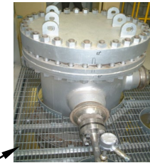
Heガス熱交換型 反応器(水蒸気改質器)
