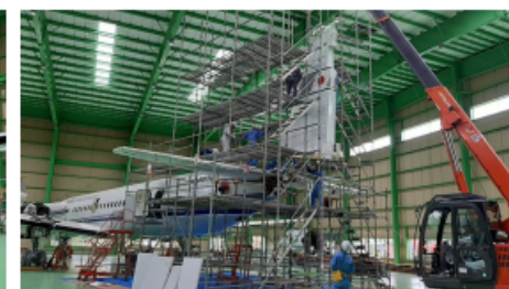
尾翼取付作業
