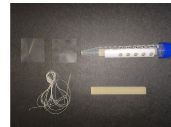
「江戸っ子1号」を利用した深海底での生分解プラスチック分解試験 https://www.jamstec.go.jp/j/about/press_release/20200305/
