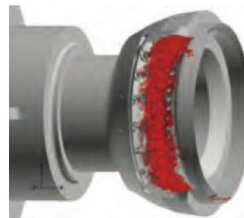
航空機用ガスタービン燃焼器 燃焼流れの数値解析
