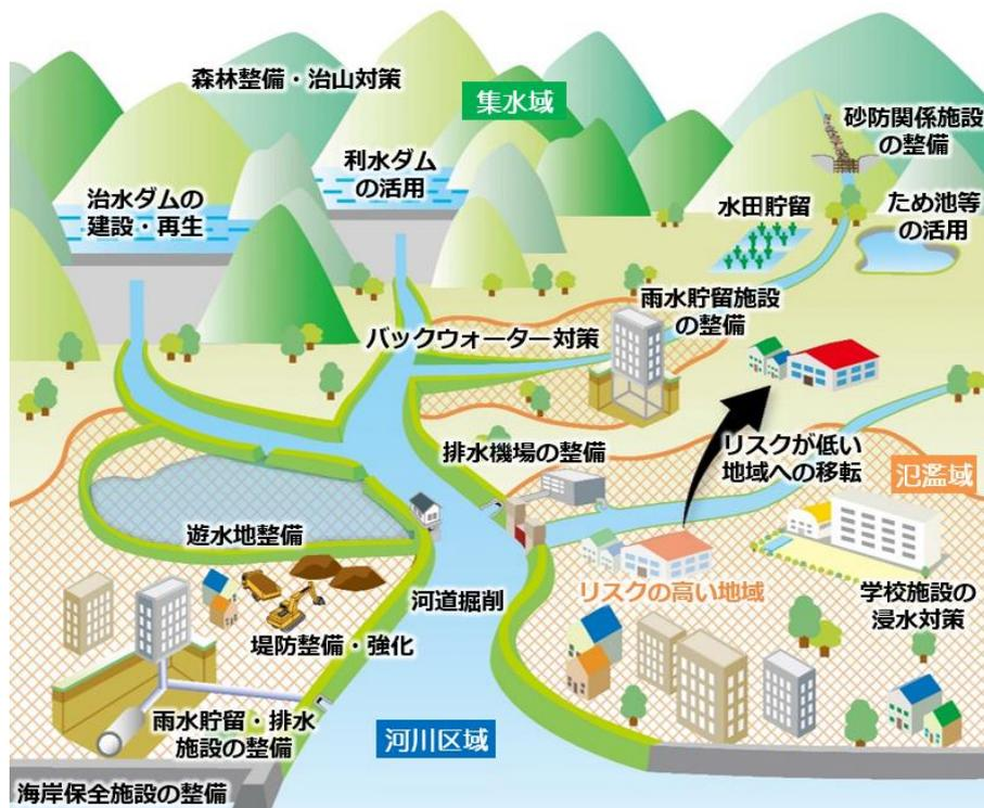
図2 流域治水対策のイメージ<sup>2</sup>
