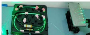
レーザー光を複数のファイバに分岐する
