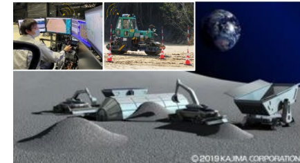
遠隔施工システムの実現 (宇宙探査イノベーションハブ研究の一例)
