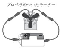
ひろしさん: かん電池の+極からモーターを通過して-極へ電気が流れていて、モーターを通る前とあとの電気の量は、同じだと思うよ。
