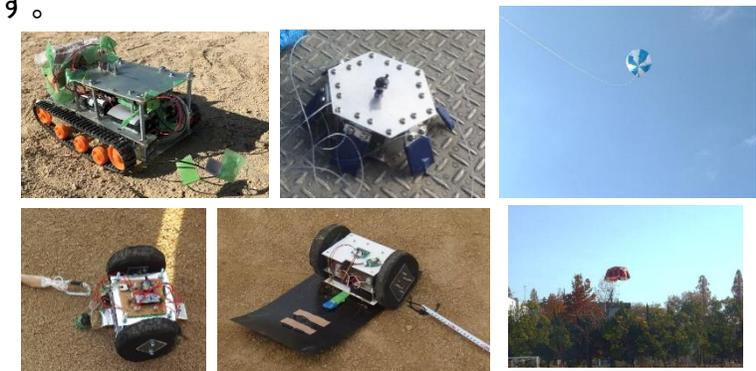
図4: 学生が制作したCanSatと気球放出実験の様子
