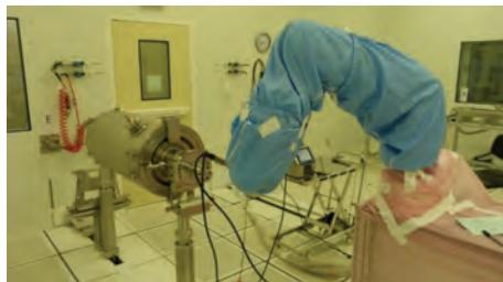
フランス・サクレー研究所では、ロボット技術をESS空洞に適用し、ダスト混入を排除したクリーンルーム組立を開始
