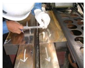
①平板試験によるひずみ計測
