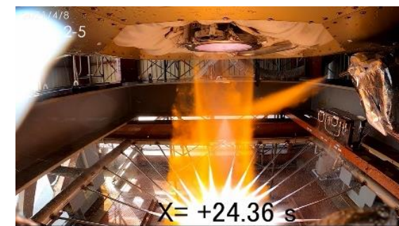
2021年4月8日、能代ロケット実験場で行われた地上燃焼試験(#2-5)の100%推力時の様子
