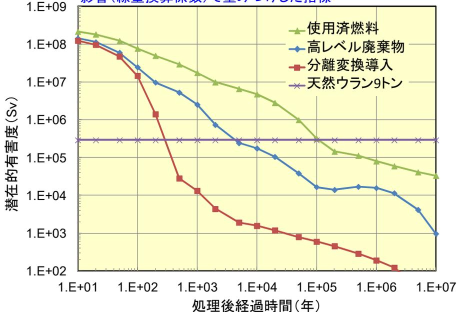
燃焼度43GWD/t、5年冷却後の再処理でUとPuを99.5%除去。
