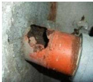
劣化による配管破損
