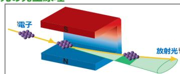
光速近くまで加速した電子に磁場をかけて軌道を曲げたときに接線方向に放射光が発生
