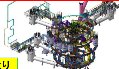
冷媒配管、超伝導コイル、遮熱板からなる被冷却機器
