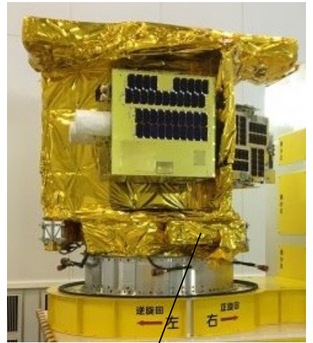
キューブサット放出装置を複数衛星搭載構造に取付
