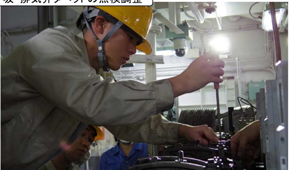
吸・排気弁タペットの点検調整
