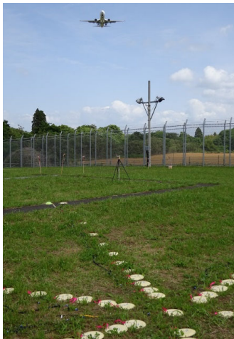
成田空港での測定の様子と計測した音源分布
