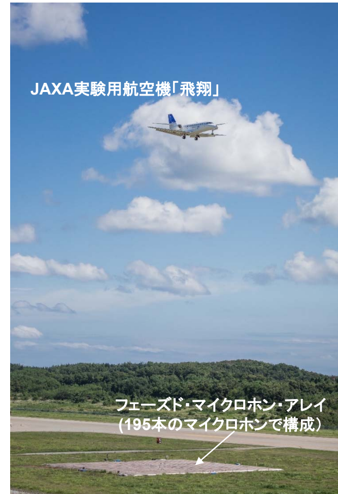
騒音源計測のために、のと里山空港の着陸帯に設置したフェーズド・マイクロホン・アレイとその上空を低空飛行する実験用航空機「飛翔」
