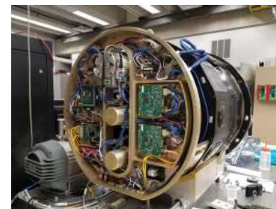
米国ジョーンズ・ホプキンス大学で組み立て中の、PFS向け近赤外カメラ
