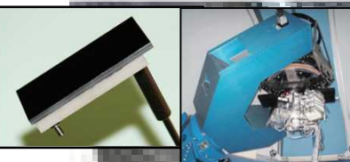
すばる用に開発された高感度可視光センサ（左）とそれを搭載したデブリ探索望遠鏡（右）
