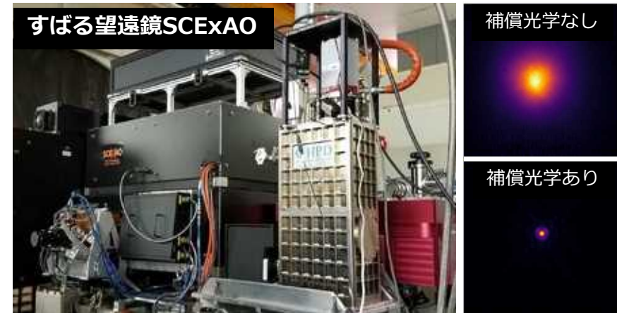
(左) すばる望遠鏡向けに開発された極限補償光学装置SCEXAO (右) 補償光学適用前(上)と適用後(下)での星像の違い。 補償光学により、星像が圧倒的にシャープになる。
