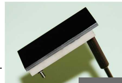
左：開発した2K×4K 画素のCCD 下：同 CCDを116個配置し た、すばる望遠鏡超 広視野主焦点カメラ HSC
