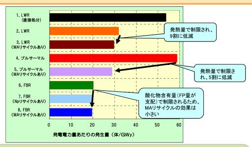
■ MAをリサイクルした場合、発電電力量あたりのガラス固化体発生量は以下の通り。
