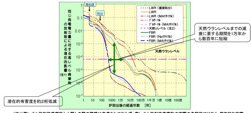
(注1)高レベル放射性廃棄物と人間との間の障壁は考慮されておらず、高レベル放射性廃棄物の実際の危険性ではなく、潜在的な有害度(経口摂取による年摂取限度で規格化)を示している。使用済燃料取り出し直後の潜在的影響を1とした相対値。
