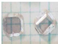
←人工的に合成したダイヤモンド。量子センサの材料となる
