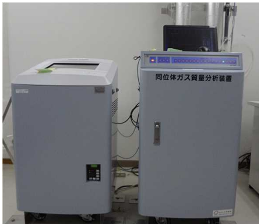
^{12}\text{CO}_2 及び ^{13}\text{CO}_2 ガス濃度制御用の 同位体ガス質量分析装置
