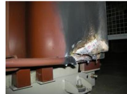
変圧器の発火による損傷
