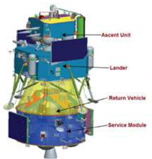
嫦娥5号の構成 [打上質量8.2トン] (サービスモジュール、着陸機、アセントユニット、帰還カプセル)
