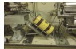
2011年 東日本大震災により、KEKの加速器の多くが被害を受けた。写真は、地震により転倒した入射器のトリプレットQマゼネット。KEKでは、多数の共同利用者に利用されているPFの復旧を優先先とするため、5月23日には震災後に初めて放射光装置を導入でき、秋からは共同利用実験を再開した。
