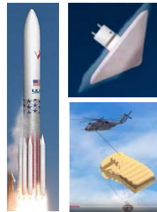
ULAが開発中のVulcanロケットと1段エンジン部の再利用のコンセプト
