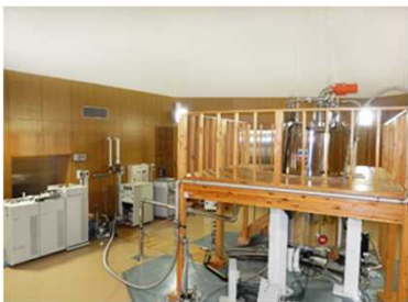
被災した北海道大学の高磁場800MHz装置
