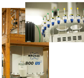
サンプルチェンジャー (自動試料装填・交換)
